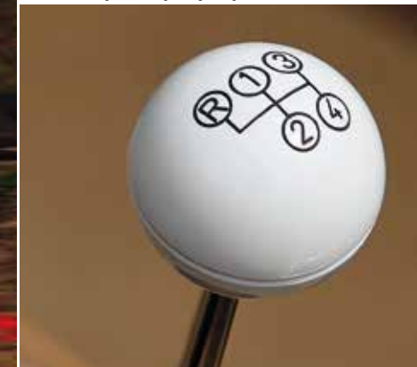
Ein Schema im Schaltknopf informiert über die Lage der Gänge des Vierganggetriebes. Im Mercedes ist ein Becker-Radio fast schon obligatorisch
