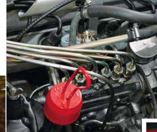
Die Gemischaufbereitung übernimmt eine Sechsstempel-Einspritzpumpe von Bosch
